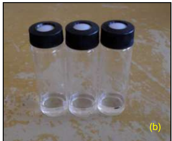
Figura 3.63 – (a) Injeção de 5 mL de solução contaminante no vial; (b) Vials fechados.
