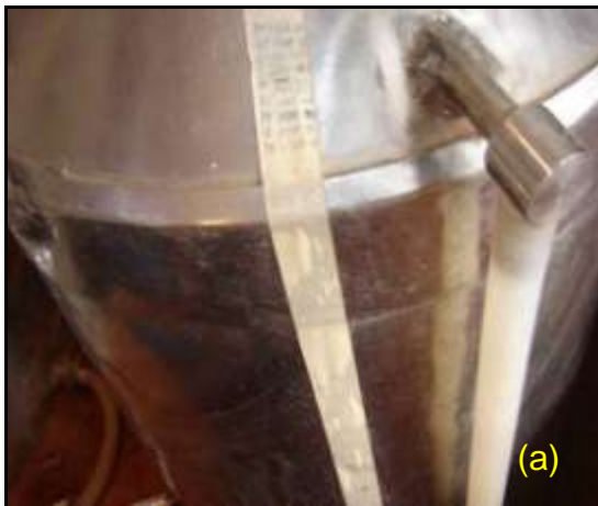
Figura 3.59 – (a) Mangueira de nível fechada; (b) Conexão frasco de Mariotte/reservatório a montante aberta.
