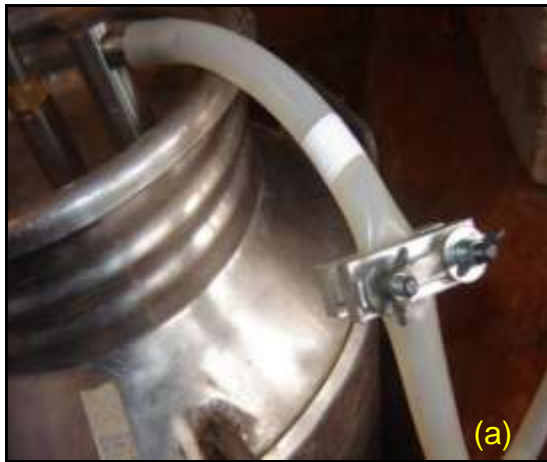
Figura 3.55 – (a) Conexão fechada entre o tambor plástico e o frasco de Mariotte; (b) Abertura da conexão entre o tambor e o frasco.
