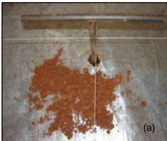
Figura 3.40 – (a) Utilização do trado até alcançar a altura de 57 cm a partir da linha de referência; (b) Finalização do furo.
