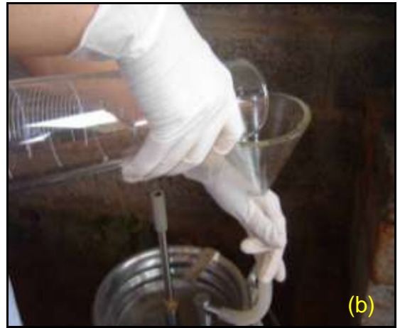
Figura 3.58 – (a) Funil de vidro utilizado para verter a mistura no frasco de Mariotte; (b) Vertendo a mistura da proveta de 1L para o frasco.
