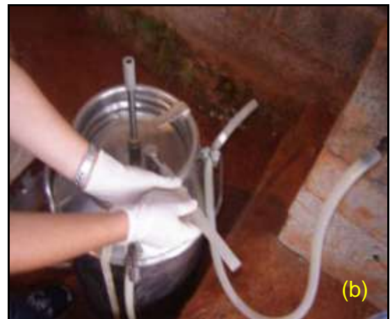
Figura 3.57 – (a) Retirada da mangueira que conecta o tambor ao frasco de Mariotte; (b) Conexão da mangueira utilizada para injetar a mistura no frasco.
