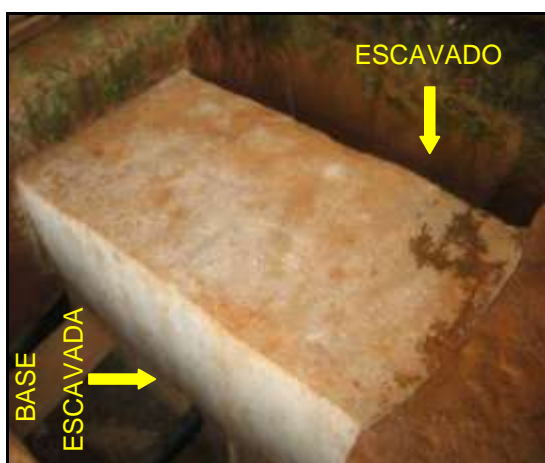
Figura 3.20 – Bloco de solo envolvido com parafina e escavações iniciais das laterais e base.
