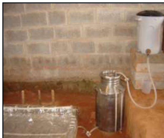
Figura 3.60 – Processo de abastecimento do frasco de Mariotte e do reservatório a montante.
