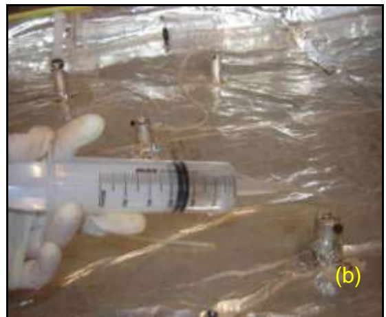
Figura 3.62 – (a) Introdução da mangueira no tubo de monitoramento; (b) Sucção da solução contaminante.
