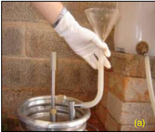
Figura 3.58 – (a) Funil de vidro utilizado para verter a mistura no frasco de Mariotte; (b) Vertendo a mistura da proveta de 1L para o frasco.
