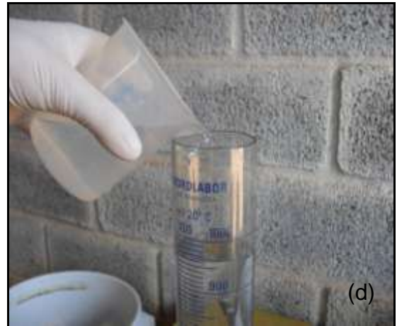
Figura 3.14 – (a) Vertendo o composto em becker de vidro; (b) Vertendo 17,10 mL do composto do becker em proveta de vidro graduada; (c) Vertendo os 17,10 mL de cada composto na proveta com 950 mL de água; (d) Completando com água o volume de 1 L da proveta.
