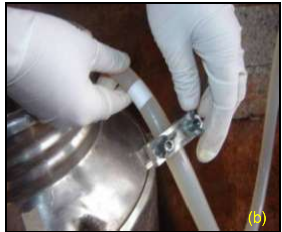
Figura 3.55 – (a) Conexão fechada entre o tambor plástico e o frasco de Mariotte; (b) Abertura da conexão entre o tambor e o frasco.
