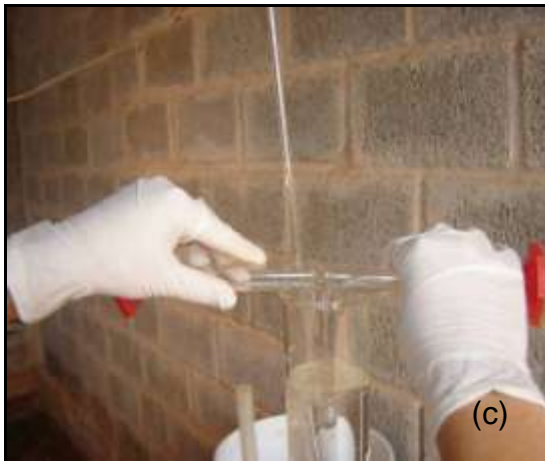
Figura 3.14 – (a) Vertendo o composto em becker de vidro; (b) Vertendo 17,10 mL do composto do becker em proveta de vidro graduada; (c) Vertendo os 17,10 mL de cada composto na proveta com 950 mL de água; (d) Completando com água o volume de 1 L da proveta.
