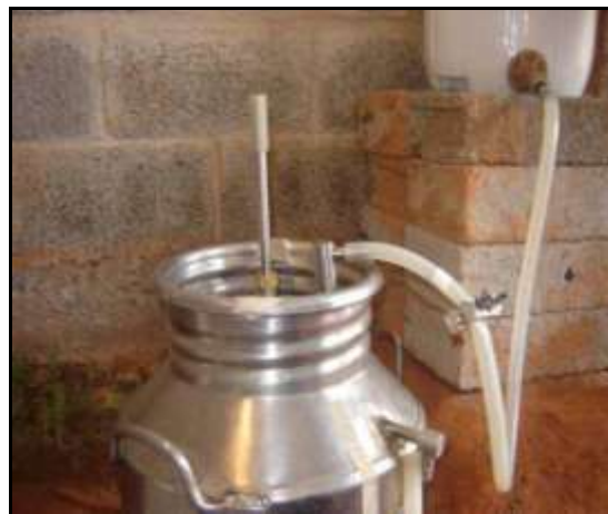
Figura 3.56 – Processo de alimentação do frasco de Mariotte com água.
