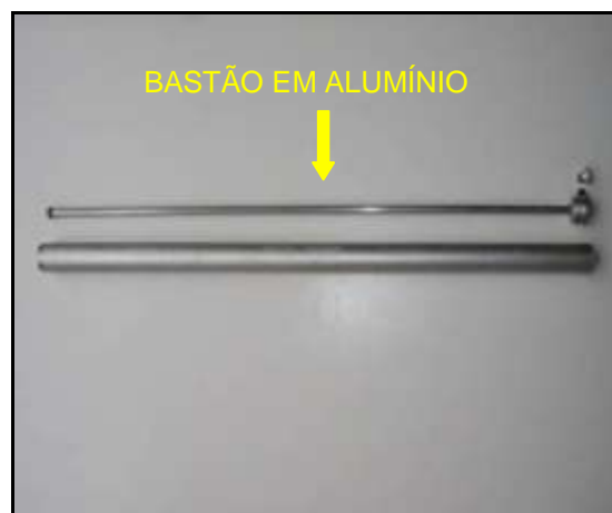
Figura 3.33 – Detalhes do tubo de monitoramento.
