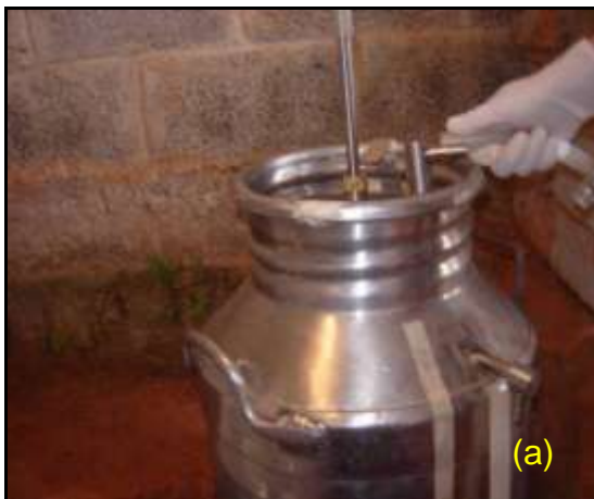
Figura 3.57 – (a) Retirada da mangueira que conecta o tambor ao frasco de Mariotte; (b) Conexão da mangueira utilizada para injetar a mistura no frasco.
