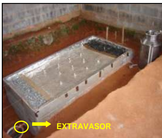
Figura 3.51 – (a) Visão geral do ensaio; (b) Detalhe do frasco de Mariotte; (c) Extravasador no reservatório a jusante.
