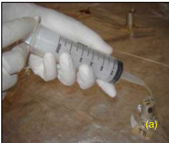
Figura 3.62 – (a) Introdução da mangueira no tubo de monitoramento; (b) Sucção da solução contaminante.
