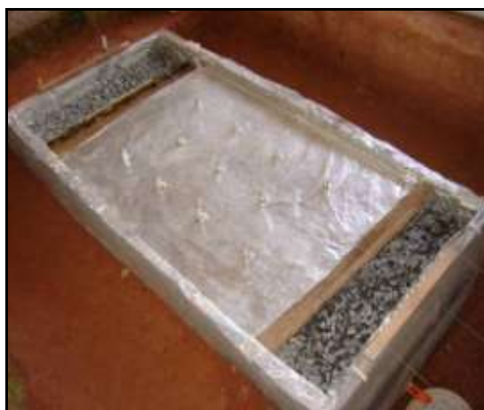
Figura 3.43 – Visão geral do lisímetro após instalação dos tubos.
