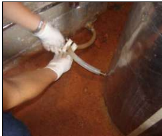
Figura 3.53 – Fechamento da conexão entre o frasco de Mariotte e o reservatório a montante.
