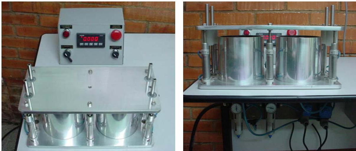
FIGURA 1. Foto do picnômetro eletrônico de comparação a ar.
