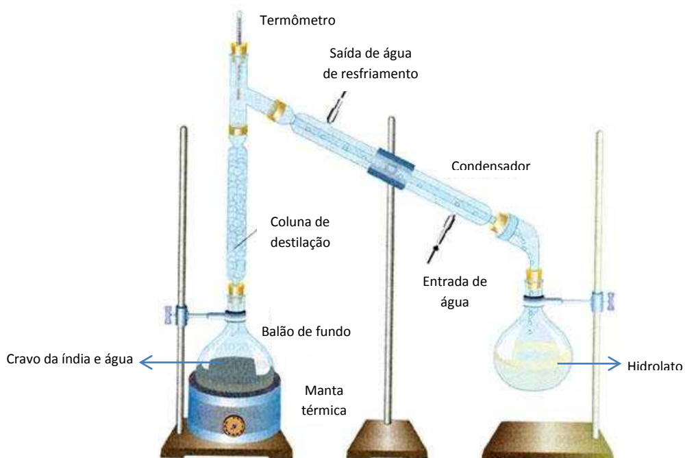
Figura 5 - Imagem ilustrativa do sistema de destilação utilizado para a obtenção do óleo essencial do cravo da índia (1).
