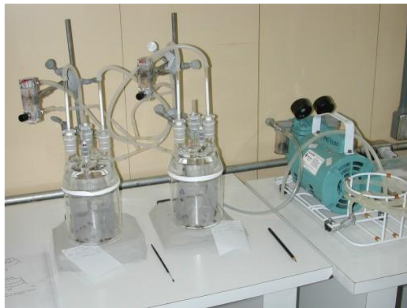
Figura 1. Sistema de aeração para coleta de voláteis emitidos por Elasmopalpus lignosellus , em câmara de vidro usando o sistema de aeração forçada.
