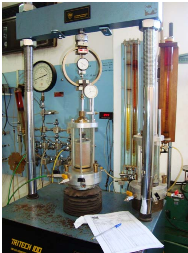
Figura 3.08: Prensa empregada no ensaio triaxial do tipo UU - Laboratório de Geotecnia – DEC/UFV
