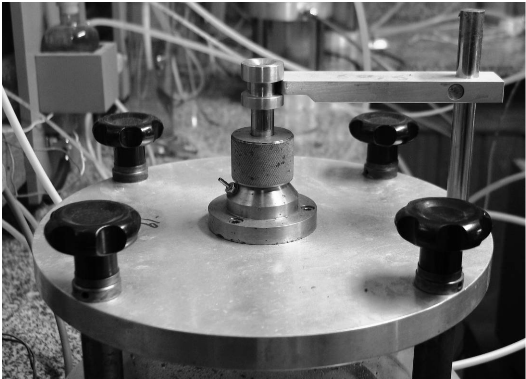
Figura 15 – Detalhe da guia do êmbolo localizado no topo da célula.
