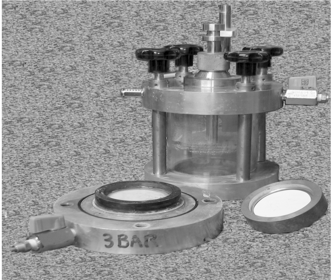
Figura 12 - Célula CRS aberta com pedra porosa de 3 bar e base da pedra porosa reserva com pedra de 1 bar.
