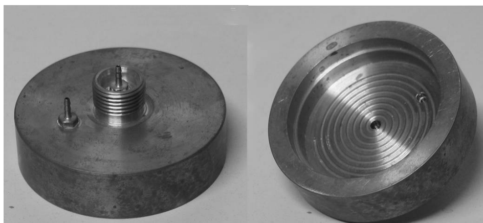
Figura 14 - Base intercambiável mostrando o detalhe da espiral.
