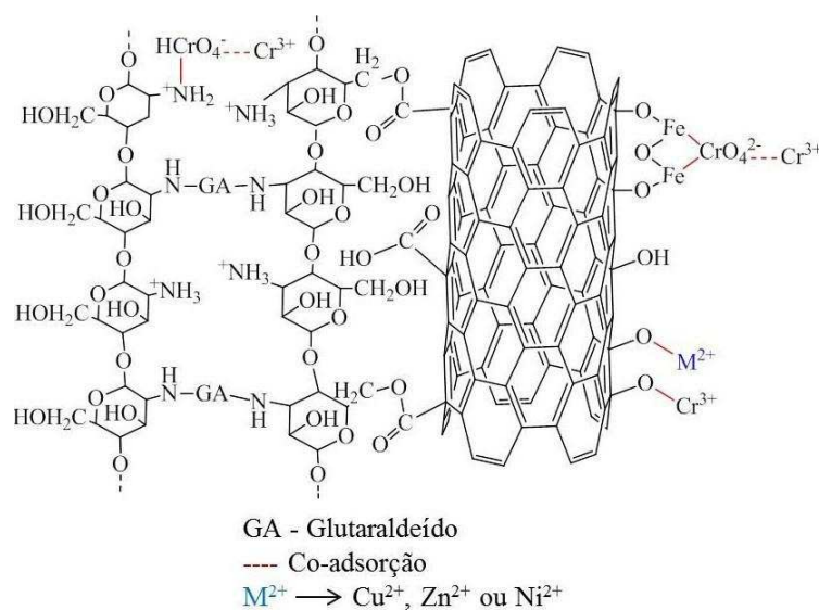
Figura 9. Proposta do mecanismo de adsorção de \text{Cr(III)} e \text{Cr(VI)} pelo filme de 10-Fe/MWCNT/QTR-0,5.
