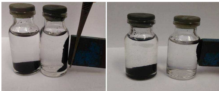
Figura C7. Imagem do catalisador 10-Fe/MWCNT/TiO 2 -Ag-9, ressaltando sua separação por aplicação de campo magnético.
