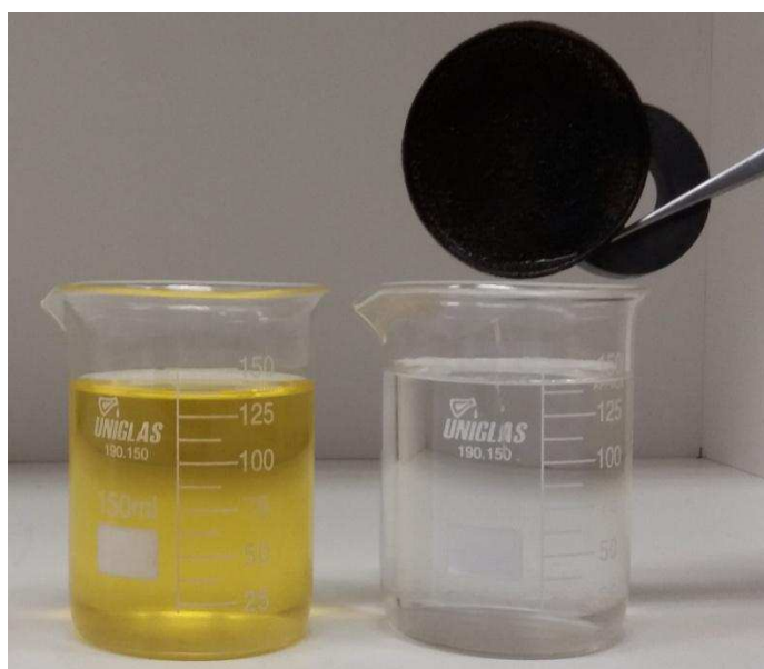
Figura A1. Imagens do filme 10-Fe/MWCNT/QTR-0,5 e da solução de Cr(VI) antes e após a adsorção.
