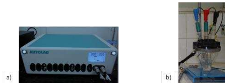
Figura 2. Instrumentação utilizada: a) potenciostato / galvanostato PGSTAT 302N e b) célula eletroquímica com arranjo de três eletrodos.
