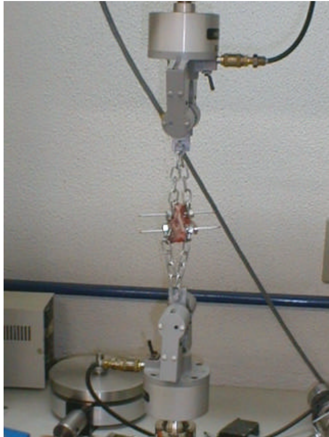
Figura 3. A avaliação biomecânica foi realizada em aparelho de teste tipo Instron, modelo 4204.
