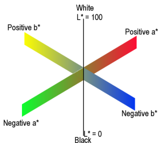
Figura 5. Sistema de coordenadas de cores CIELAB, 1976 Fonte: Star Color (2004).
