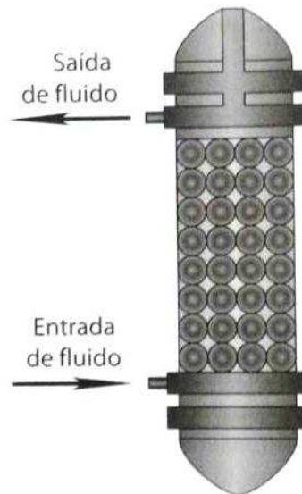
Figura 13. Modelo de reator de leito fixo. Fonte: (CREMASCO, 2012).
