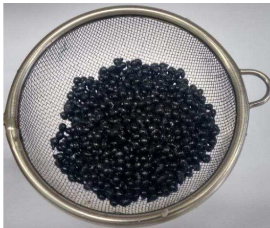
Figura 1.13. NPs Fe/Ni depositadas em esferas de quitosana.
