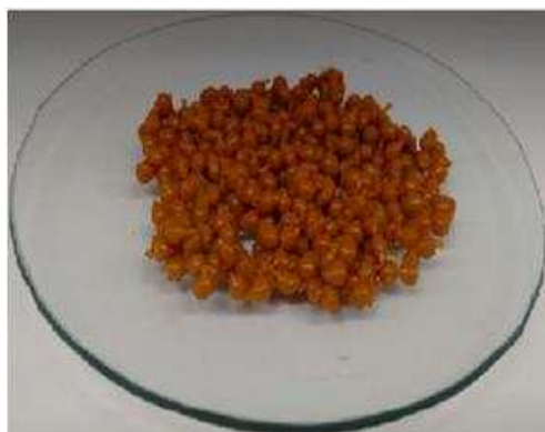
Figura 1.14. Coloração da esfera de quitosana após adsorção de ferro e níquel.
