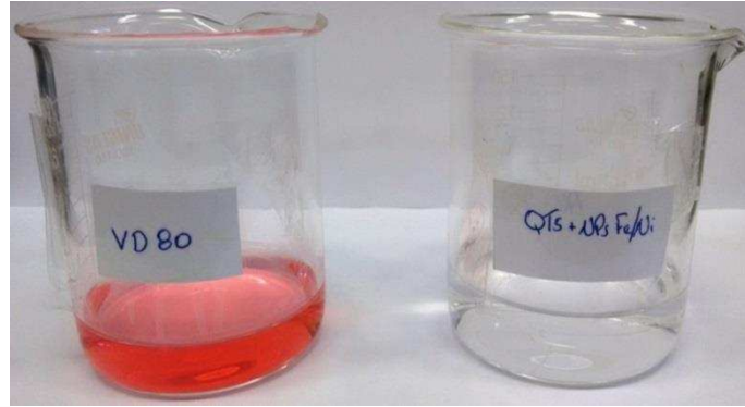
Figura 1.17. Solução do corante antes da degradação e após o tratamento com as NPs/QTS. Condições experimentais: [corante] = 10 g L -1 ; Dose equivalente de NPs Fe/Ni = 1 g L -1 ; Volume da solução = 250 mL; Temperatura ambiente.
