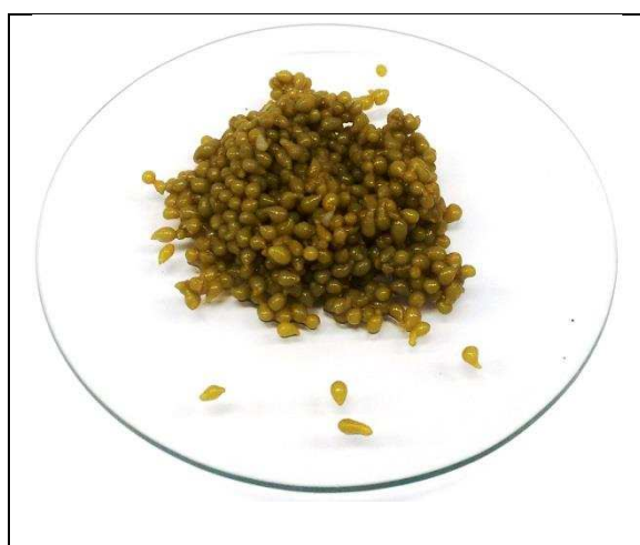
Figura 1.12. Esferas de quitosana úmida após adsorção de ferro e níquel. Condições experimentais: eQTS = 15 g, Tempo de adsorção = 15 min, c(Fe^{2+}) = 7,86 \text{ g L}^{-1} , c(Ni^{2+}) = 0,80 \text{ g L}^{-1} , Temperatura ambiente ( \sim 25 \text{ }^\circ\text{C} ).
