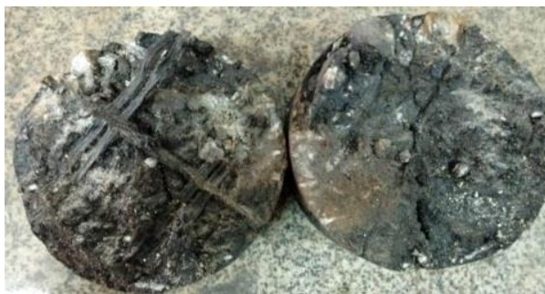
Figura 3: Geogrelha aderida à mistura asfáltica a quente. Fonte: (Autoria própria, 2018).
