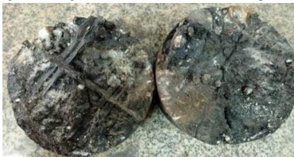
Figura 5: Geogrelha aderida à mistura asfáltica a quente.
