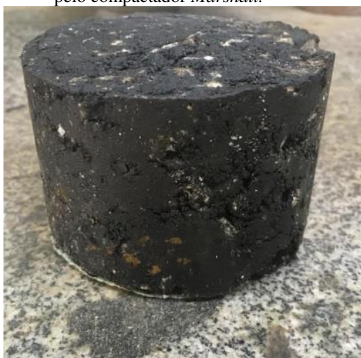
Figura 10: Corpo de prova reforçado com geogrelha moldado pelo compactador Marshall .
