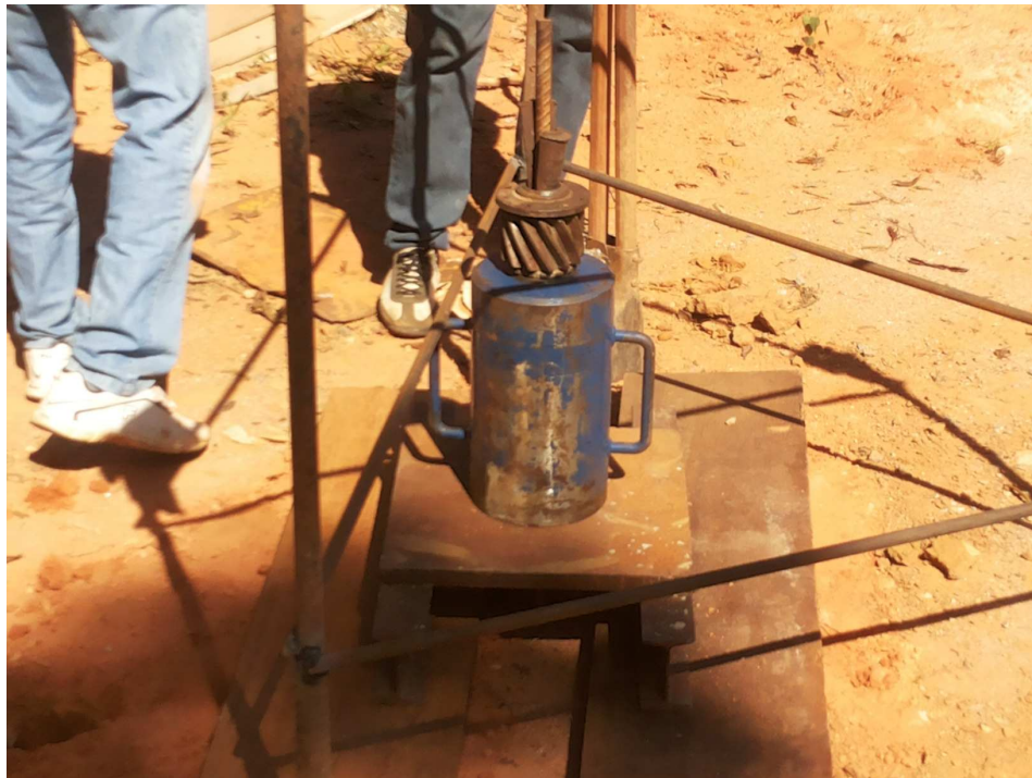
Figura 3.12 - Conjunto prolongador, cone bipartido e anel de travamento logo acima do macaco hidráulico.
