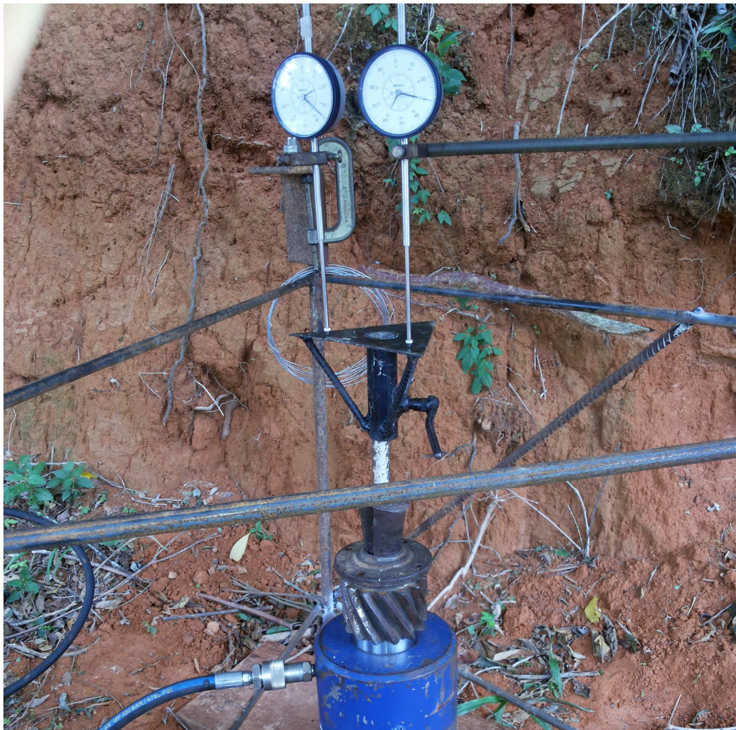
Figura 3.13 – Relógios comparadores apoiados em chapa triangular
