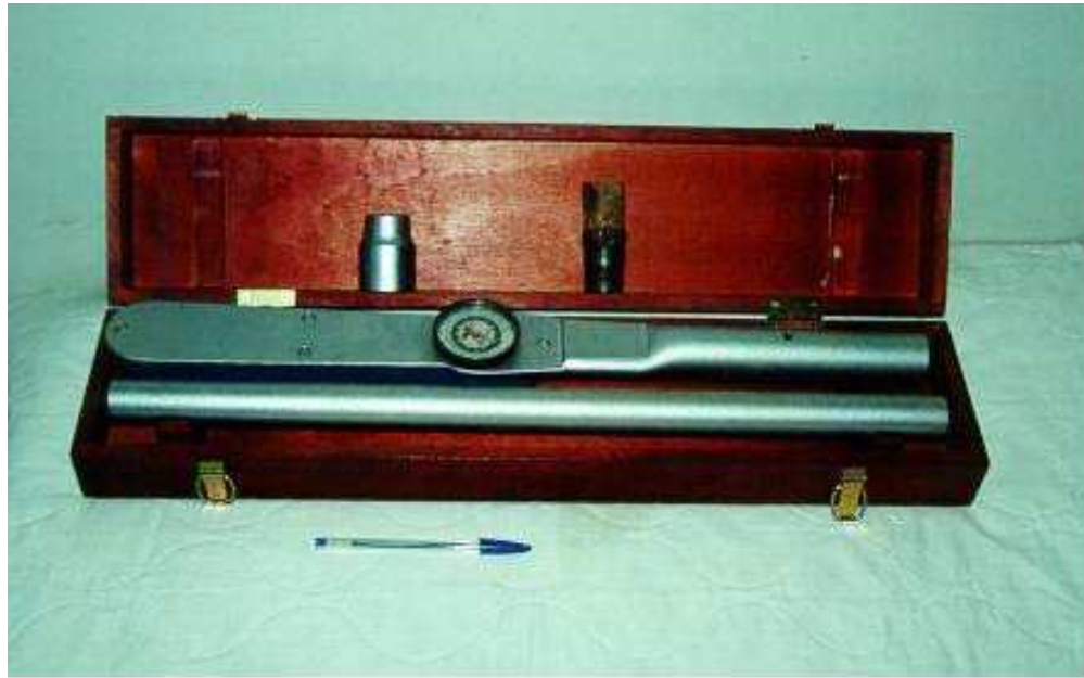
Fonte: Departamento de Engenharia Civil / UFV Figura 2.13 – Torquímetro.
