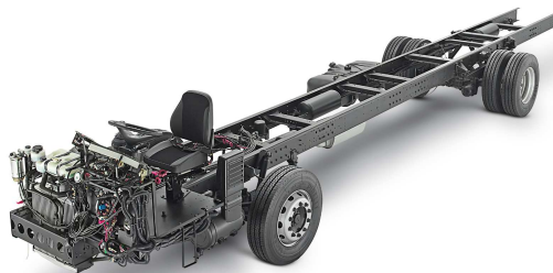
Figura 2: Vigas da estrutura de um caminhão ( fonte: http://andrecerberus.com/2012/05/ )
