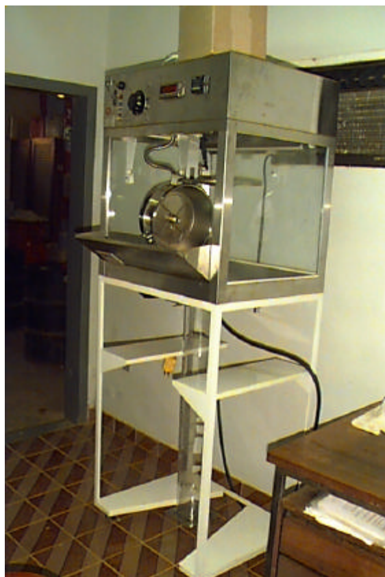
Figura 3 – Pipocador-padrão de amostras Cretors, modelo MWVT.
