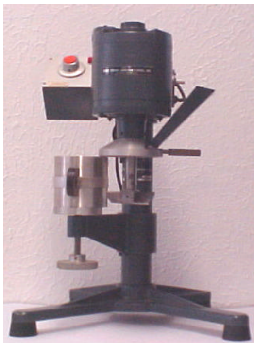
Figura 1 – Aparelho de simulação dos danos mecânicos.
