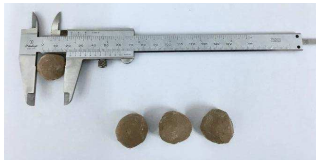
Figura 3.2. Pellets produzidos para posterior calcinação e clinquerização.
