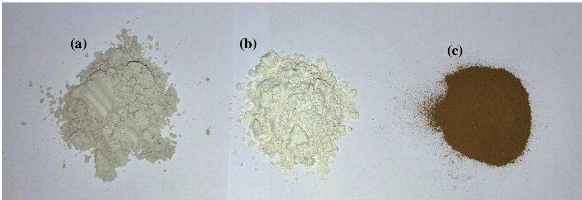
Figura 3.1. Matérias-primas utilizadas na produção do eco-clínquer. (a) grits; (b) resíduo de granito; (c) RMFR.
