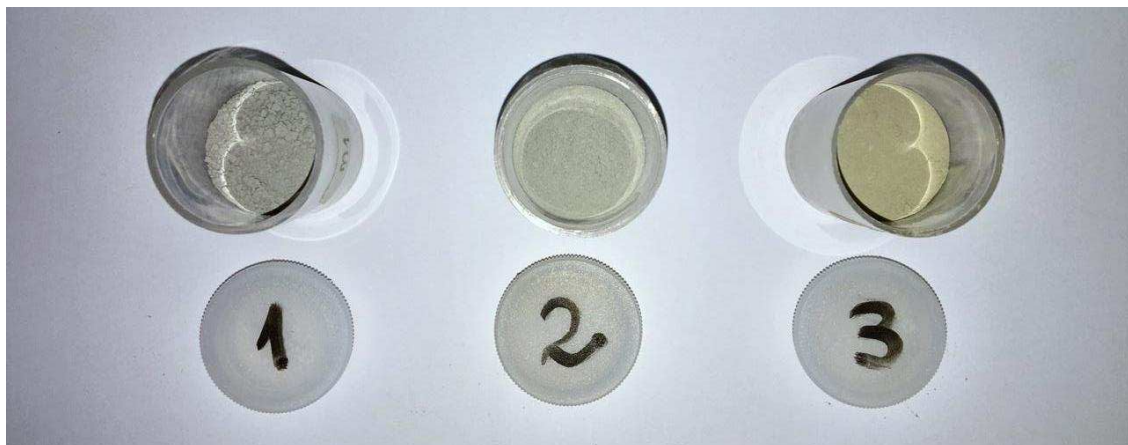
Figura 4.4. Eco-clínquer produzido a partir do reaproveitamento de resíduos industriais.
