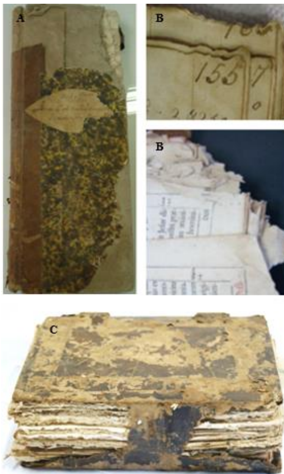
Figura 86 – A- Livro com danos nas bordas por roedores. B- Danos e marca dos dentes dos roedores. C- Danos na lombada da cobertura e nos cadernos, nos quais se observam as extremidades do festo dos fólhos roídas
