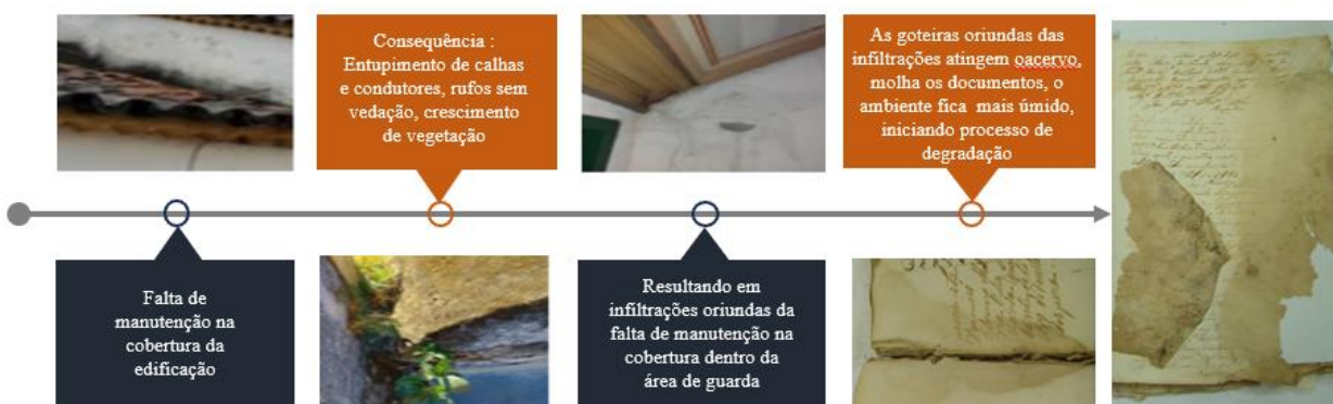
Figura 46 – Falta de manutenção da cobertura da edificação
