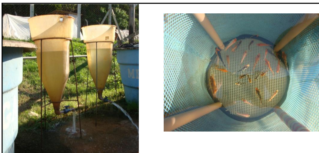
Figura 14 - Cubas coletoras de fezes e peixes no interior da cesta de acondicionamento.
