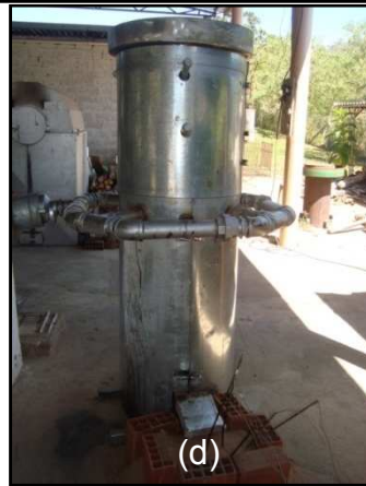
Figura 3.1 - Diagrama esquemático do gaseificador: (a) Projeto; b) Cortes do projeto com as respectivas medidas; (c) Reator da biomassa; d) Gaseificador montado.
