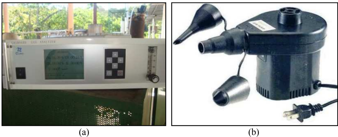
Figura 3.20 - Equipamentos utilizados para determinar as concentrações de CO e CO 2 no ar quente de exaustão: (a) analisador de gás; b) bomba de ar.
