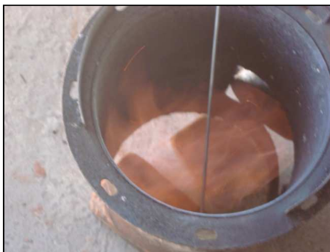
Figura 4.2 - Aparência da chama obtida na queima do gás.
