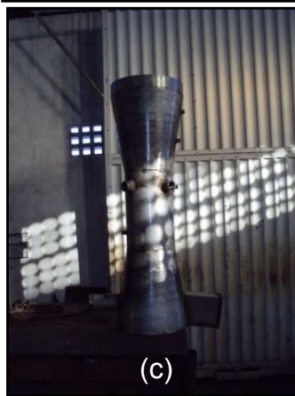
Figura 3.1 - Diagrama esquemático do gaseificador: (a) Projeto; b) Cortes do projeto com as respectivas medidas; (c) Reator da biomassa; d) Gaseificador montado.
