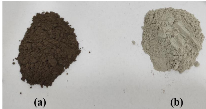
Figura 3 - Amostras moídas das escórias de aciaria elétrica empregadas na pesquisa: (a) EAEP; (b) EAES
