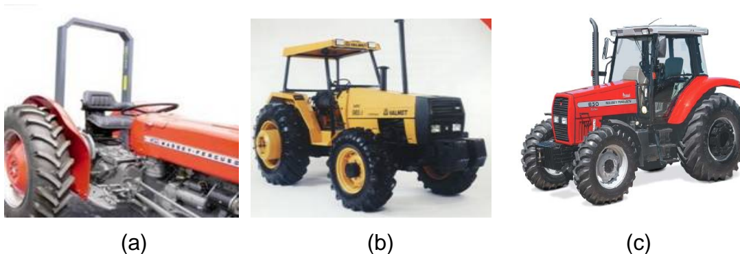
Figura 1: EPC de 2 pontos (a); EPC de 4 pontos (b); Cabina de segurança (c) Fonte: Corrêa et al., 2003
