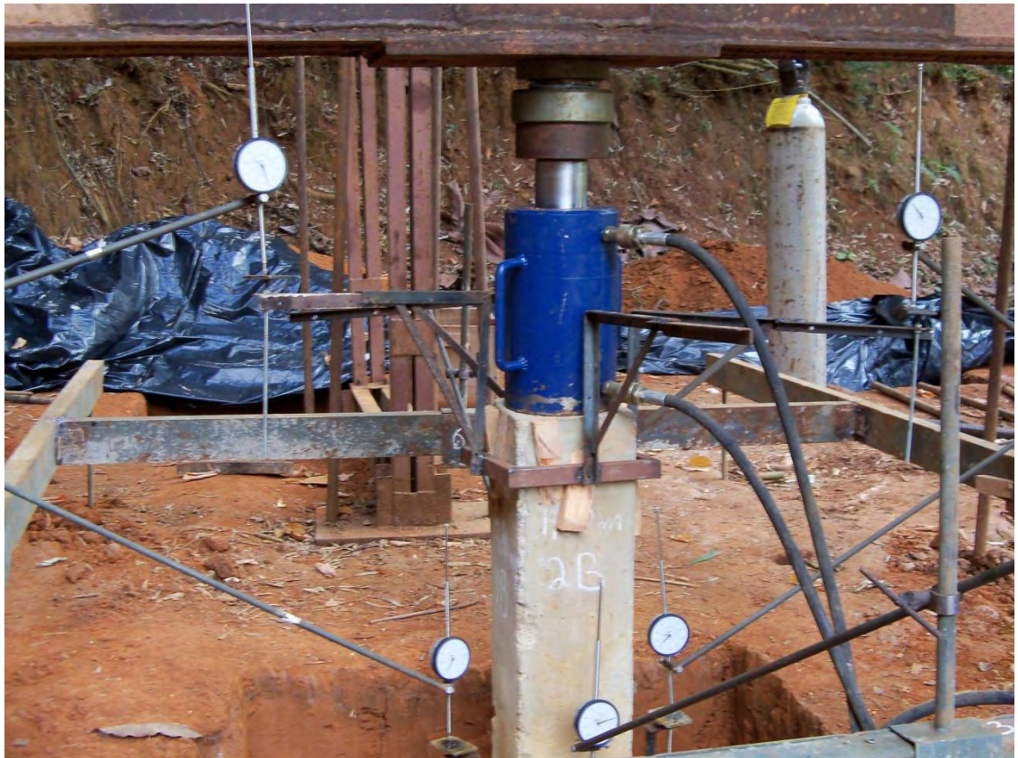
Figura 39 – Arranjo geométrico dos extensômetros utilizados na Prova de Carga.
