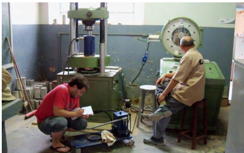
Figura 30 – Calibração do macaco hidráulico com manômetro no LMC.
