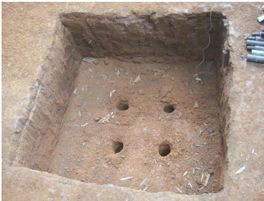
Figura 34 – Detalhes da prova de carga 03 com quatro estacas.
