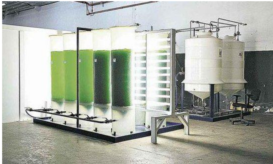
Figura 1 – Exemplo de cultivo de microalgas em fotobiorreatores fechados.
