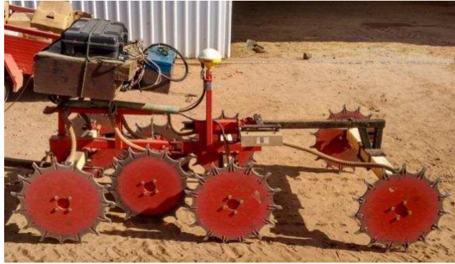
Figura 2. Equipamento ARP ® de mensuração da condutividade elétrica aparente do solo nas profundidades de 0,50, 1,00 e 2,00 metros.
