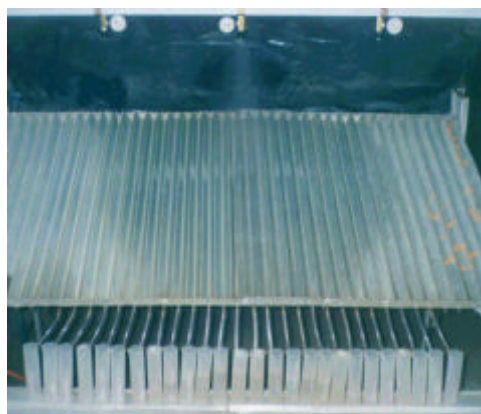
Figura 1. Bancada para medição da uniformidade de distribuição volumétrica com as provetas coletoras.
