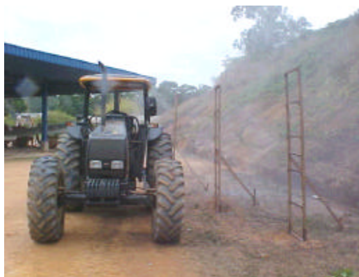
Figura 4. Posicionamento dos suportes para fixação das ripas com folhas e etiquetas amostradoras em relação ao deslocamento do conjunto trator/pulverizador.
