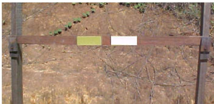
Figura 3. Etiquetas amostradoras de papel sensível a água e papel “contact” dispostas nas ripas.
