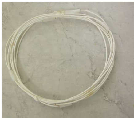
Figura 2. Módulo de membrana submerso utilizado nos reatores.
