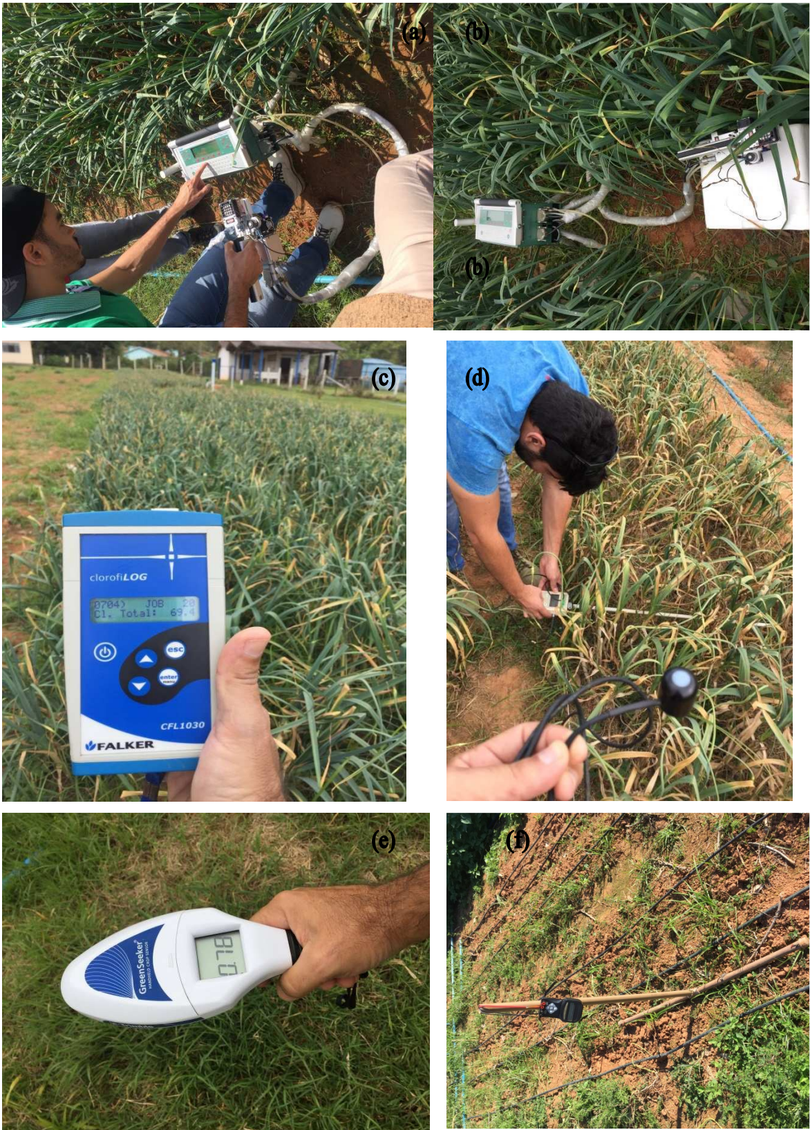
APÊNDICE C - (a) Aparelho Irga; (b) Aparelho Irga (c) Clorofilog; (d) determinação do índice de área foliar; (e) determinação do NDVI, e (f) determinação da condutividade elétrica do solo
