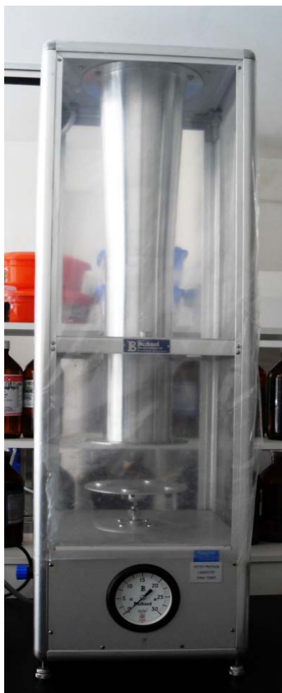
Figura 6 - Torre de Potter na qual os discos de folhas de pimenteira foram pulverizados, com diferentes concentrações de Neempro, Organic neem e Natuneem.
