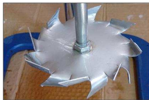
Figura 5. Preparação dos pigmentos: a) secagem ao ar; b) detalhe do disco Cowles .
