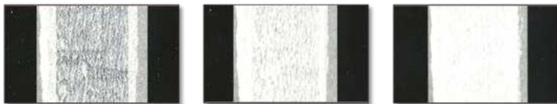
Figura 10. Amostra 11 da tinta aplicada nas Cartelas BYK ref. PA 2811 com 1, 2 e 3 demãos respectivamente.
