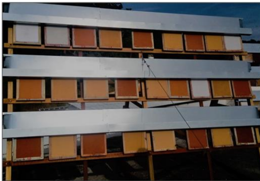
Figura 12. Ensaio de resistência ao intemperismo com a utilização de 26 quadros, com 3 demãos de cada amostra de tinta, posicionados em um painel fixo.
