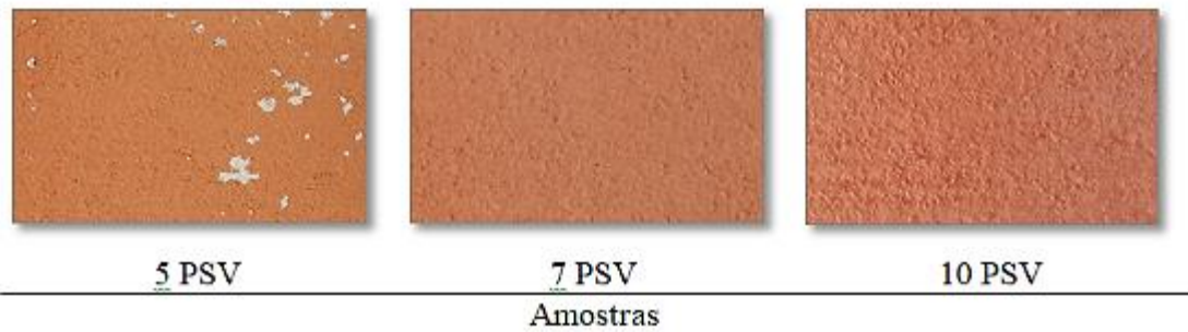
Figura 38. Tintas à base de solo vermelho após 26 semanas de exposição com acréscimos progressivos no percentual de PRM.
