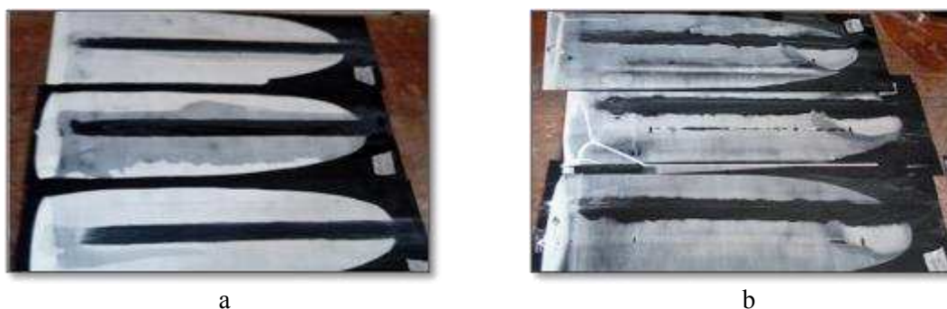
Figura 11. Cartelas de PVC após o ensaio de resistência à abrasão: a) Amostra de tinta 11; b) Amostra de tinta 13.
