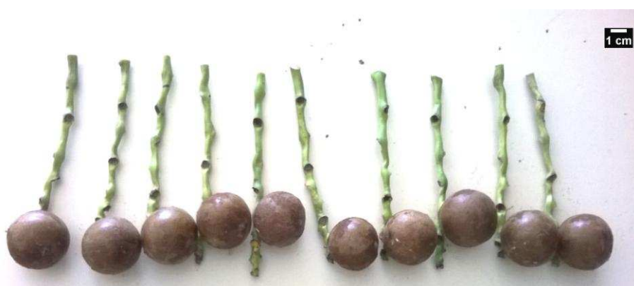
Figura 2: Amostras de ráquilas com um fruto cortadas dos cachos de macaúba e utilizadas nos ensaios de vibração.
