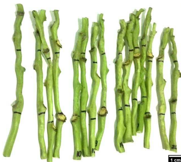
Figura 1: Amostras de ráquilas cortadas dos cachos de macaúba e utilizadas nos ensaios de tração.
