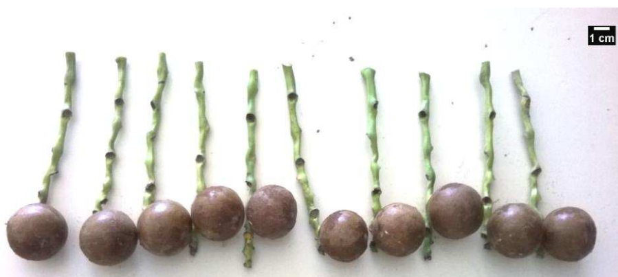
Figura 8: Amostras de ráquilas com um fruto cortadas dos cachos de macaúba e utilizadas nos ensaios de vibração.
