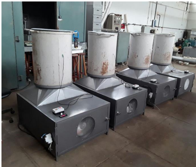
Figura 3- Secadores utilizados no experimento para secagem dos tubérculos de Cyperus rotundus .
