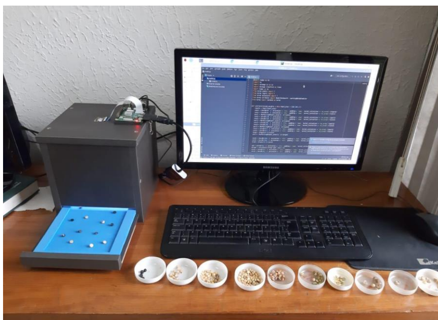
Figura 4. Protótipo para obtenção de imagens digitais de amostras de grãos de soja.
