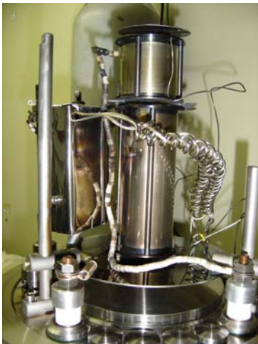
Figura 31: Fornos do sistema de crescimento HWE do Laboratório de Epitaxia do DPF – UFV.
