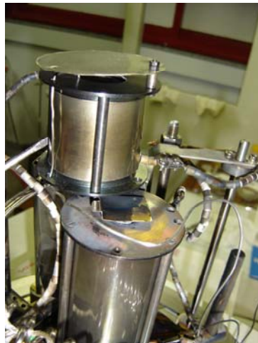
Figura 31: Fornos do sistema de crescimento HWE do Laboratório de Epitaxia do DPF – UFV.
