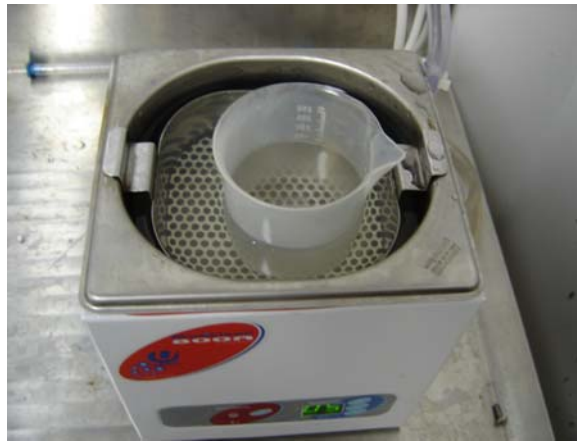
Figura 28: Sistema de ultra-som usado para limpar o substrato de Si.
