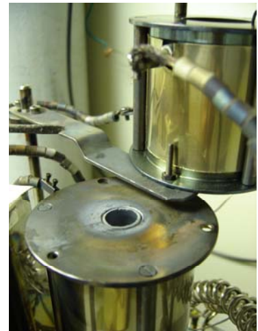
Figura 31: Fornos do sistema de crescimento HWE do Laboratório de Epitaxia do DPF – UFV.
