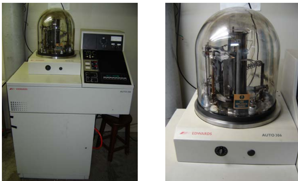
Figura 30: Sistema de crescimento HWE do Laboratório de Epitaxia do DPF – UFV.
