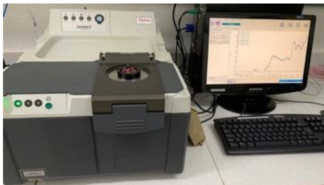
Figura 2. Análise no NIR no Espectrômetro Thermo Scientific, modelo Antaris II. Fonte: Autora (2022)
