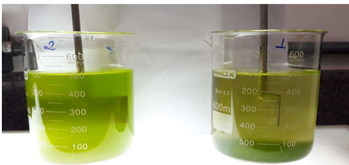
Figura 4.3 – Coagulação-floculação de microalgas sem adição de G. ulmifolia (à esquerda) e com coagulante (à direita) correspondentes aos ensaios 9 e 11, respectivamente (Tabela 4.3)
