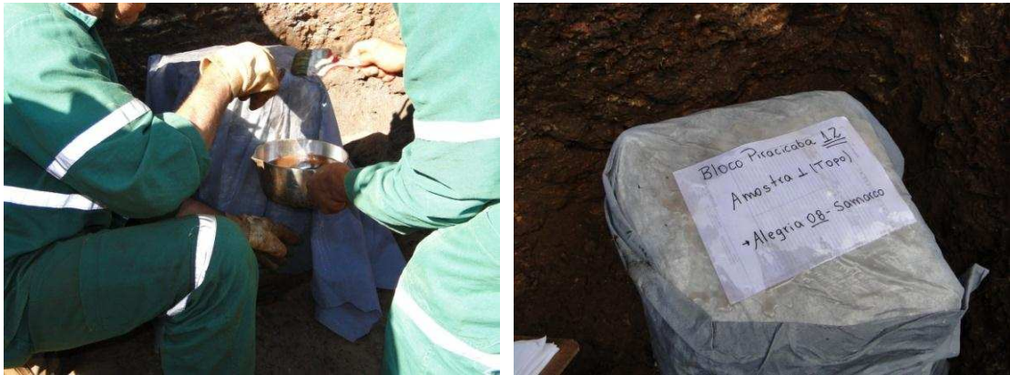
Figura 4-3: Processo de parafinamento e identificação da amostra.
