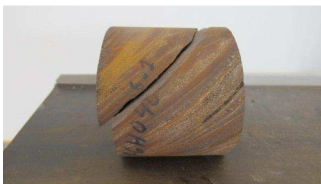
Figura 4-8: Corpo de prova cujo teste foi invalidado (BAPTISTA, 2012).
