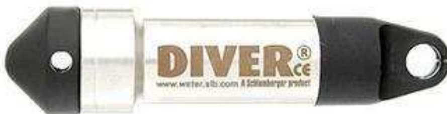
Figura 4-13: Medidor de Nível Automático – Diver .
