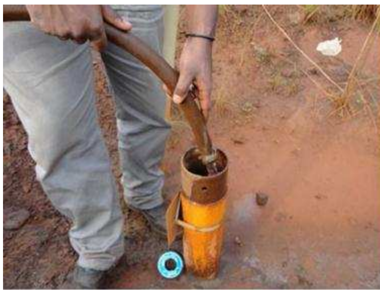
Figura 4-14: Injeção de água no piezômetro para realização do ensaio.
