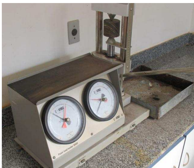
Figura 4-7: Equipamento utilizado no ensaio de resistência à compressão puntiforme (BAPTISTA, 2012).
