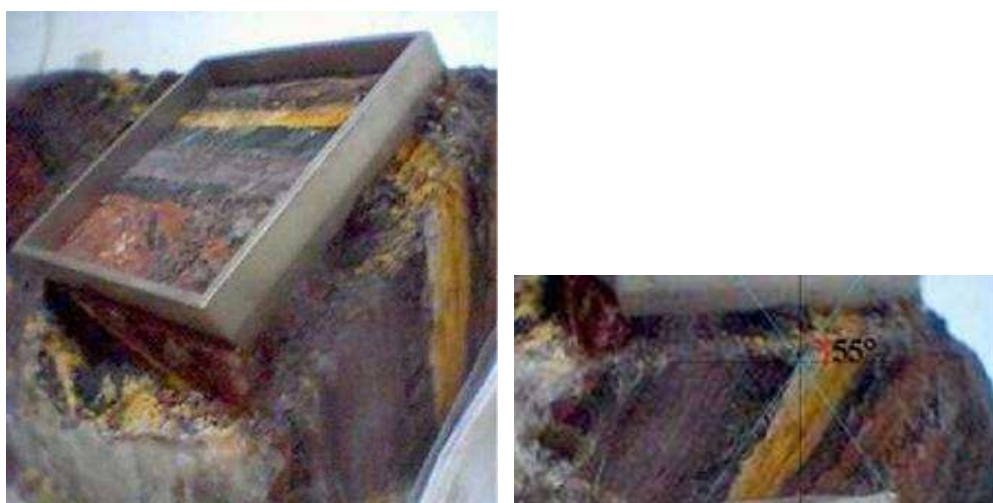
Figura 4-5: Moldagem dos corpos-de-prova (foliação oblíqua ao plano de ruptura) - Amostra IBG 345 VI.
