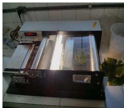
Figura 3- integrador de área foliar de bancada LI-3100C
