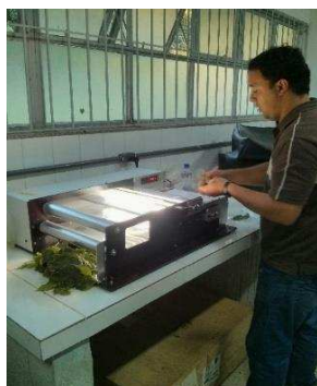
Figura 3- integrador de área foliar de bancada LI-3100C
