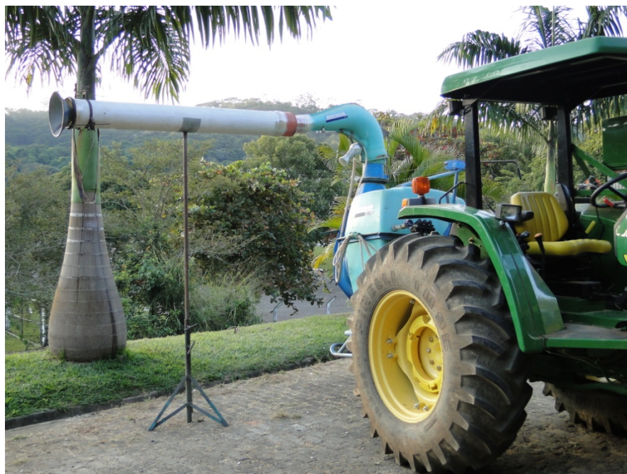
Figura 4 - Pulverizador pneumático e tubo homogeneizador.
