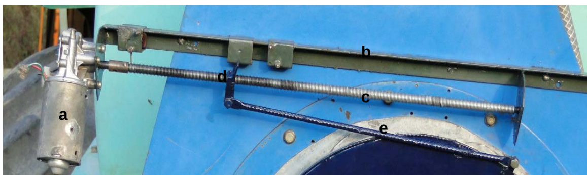
Figura 6 - Sistema eletromecânico para movimentação do diafragma. (a) motor elétrico, (b) cantoneira, (c) parafuso de potência, (d) porca, (e) tirante de ferro.
