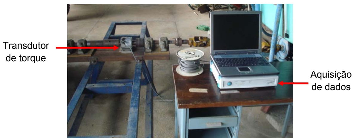
Figura 5 - Transdutor de torque entre o trator e o pulverizador e equipamentos de aquisição dos dados.
