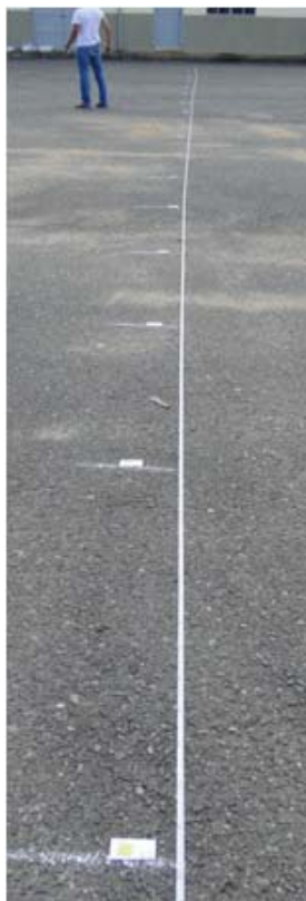
Figura 7 - Disposição das etiquetas hidrossensíveis na faixa de aplicação.
