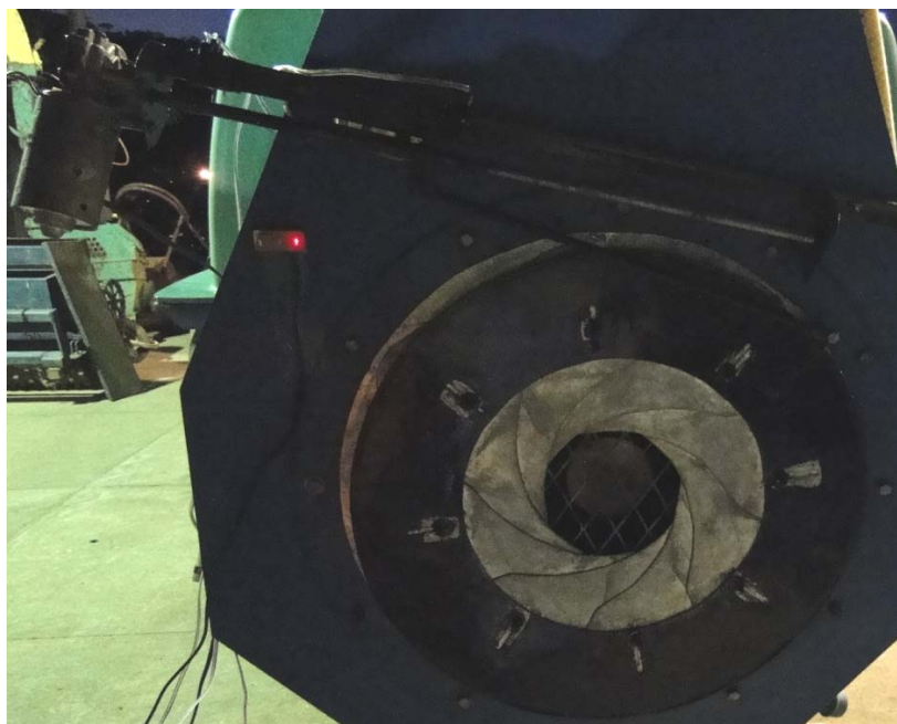
Figura 37 - Sinalização do sistema eletrônico para altos valores de déficit de pressão.
