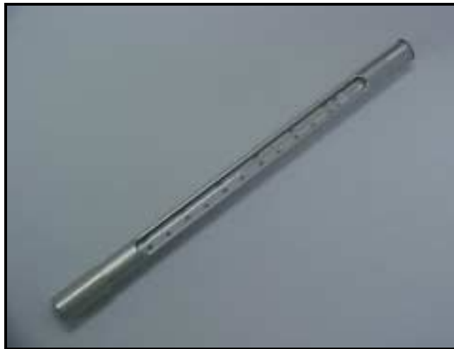
Figura 19 - Termômetro de mercúrio em vidro com certificado de padronização.
