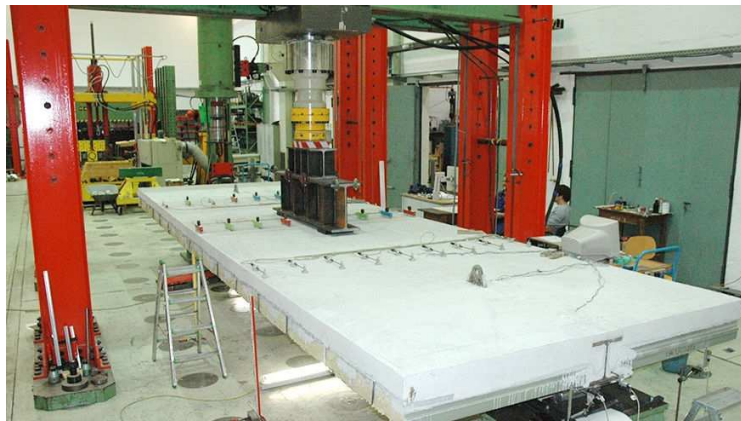
Figura 2.8 - Teste de flexão nas vigas mistas de slim floor do sistema CoSFB
