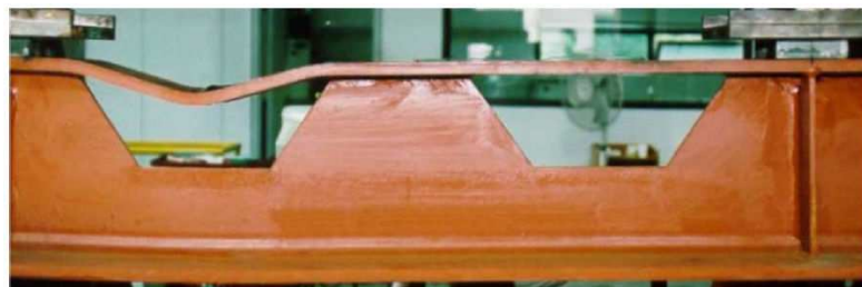
Figura 2.2 - Viga isolada ensaiada por Ju, Chun e Kim (2009).
