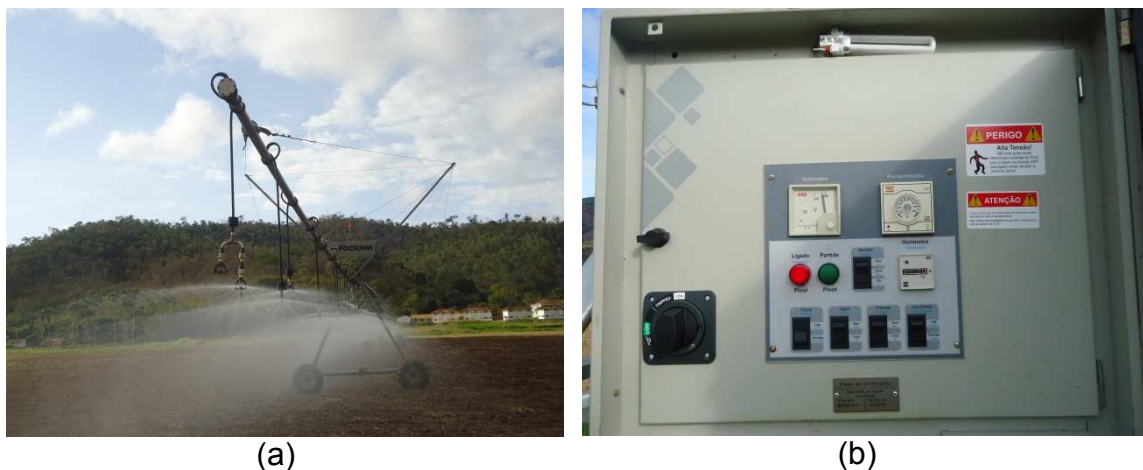
Figura 9 - Pivô central: (a) torres de irrigação e (b) painel automatizado.
