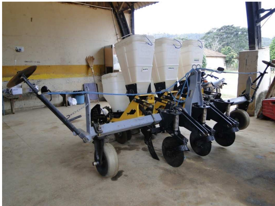
Figura 8 - Semeadora-adubadora utilizada no experimento, após adaptações nas peças.
