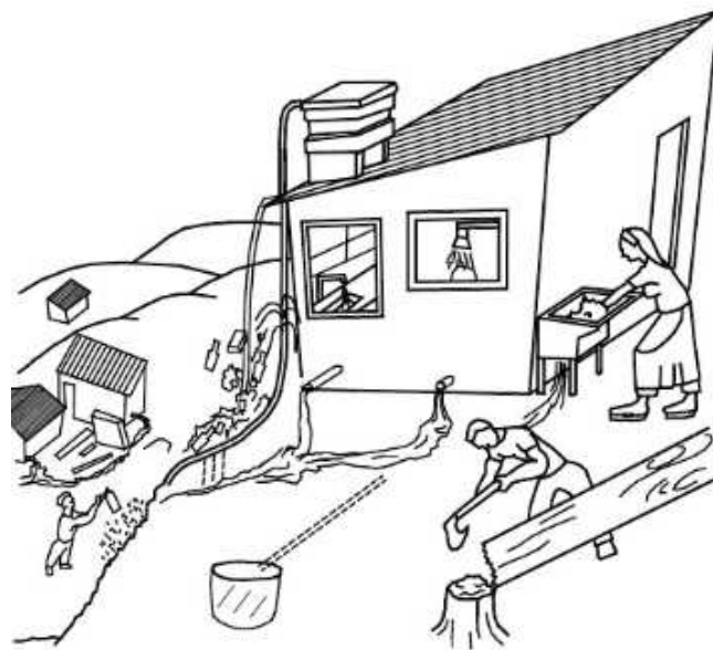
Figura 12: Practicas erradas en asentamientos en encostas. Fuente: Jaime Suarez. 1998.
