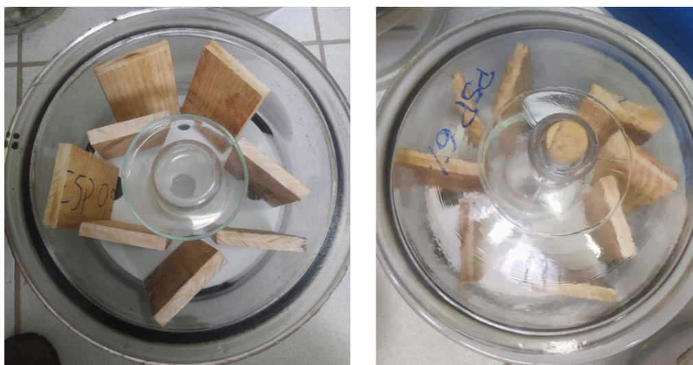
Figura 2 – Extração de formaldeído pelo método dessecador
