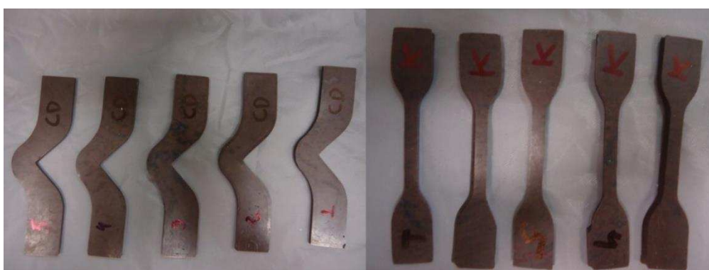
Figura 67. Corpos de prova utilizados nas análises de rasgamento (a esquerda) e tração (a direita)
