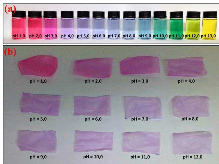
Figura 6. Comportamento do AERC em diferentes valores de pH (a) e do filme TRAc-4 contendo AERC em diferentes valores de pH (b).
