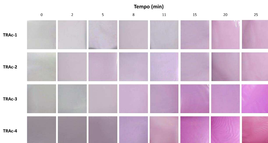
Figura 8. Comportamento visual da mudança colorimétrica de filmes de AC contendo diferentes quantidades de AERC na presença de ácido acético em diferentes tempos.
