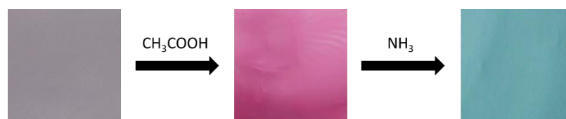
Figura 10. Comportamento para a reversibilidade de cor do filme TRAc-4 na presença de ácido acético e, logo em seguida, amônia.
