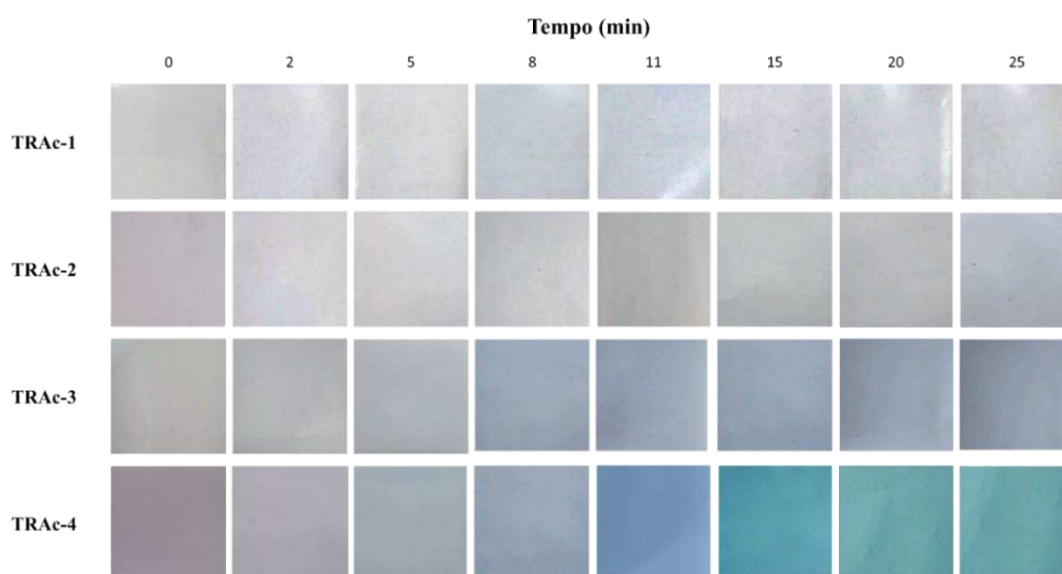
Figura 4. Comportamento da mudança visual de filmes contendo diferentes concentrações de AERC nos tempos de 0, 2, 5, 8, 11, 15, 20 e 25 min de contato com um mesmo ambiente contendo amônia volátil.
