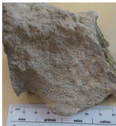
Figura 34 – Exemplo de arenito na classe de Intemperismo III (MW). À esquerda amostra de mão e à direita imagem tirada em lupa com aumento de 80x.
