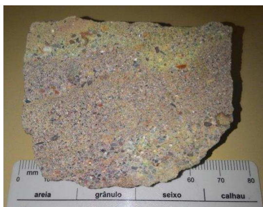
Figura 35 – Exemplo de arenito na classe de intemperismo III/IV (MW a HW). À esquerda amostra de mão e à direita imagem tirada em lupa com aumento de 80x.
