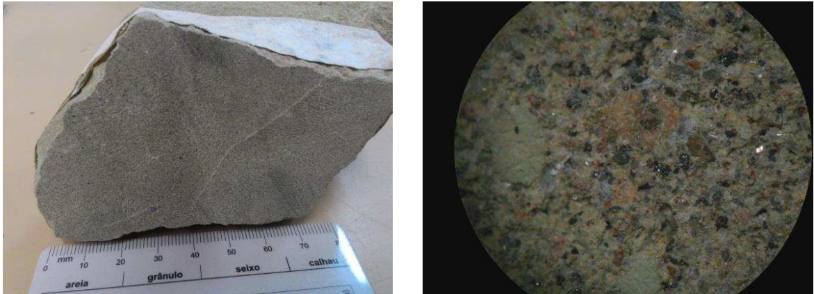
Figura 30 – Exemplo de arenito na classe de intemperismo I (SR). À esquerda amostra de mão e à direita imagem tirada em lupa com aumento de 80x.
