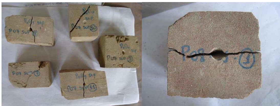
Figura 23 - Exemplo de amostras utilizadas nos ensaios de compressão puntiforme após a execução dos ensaios.
