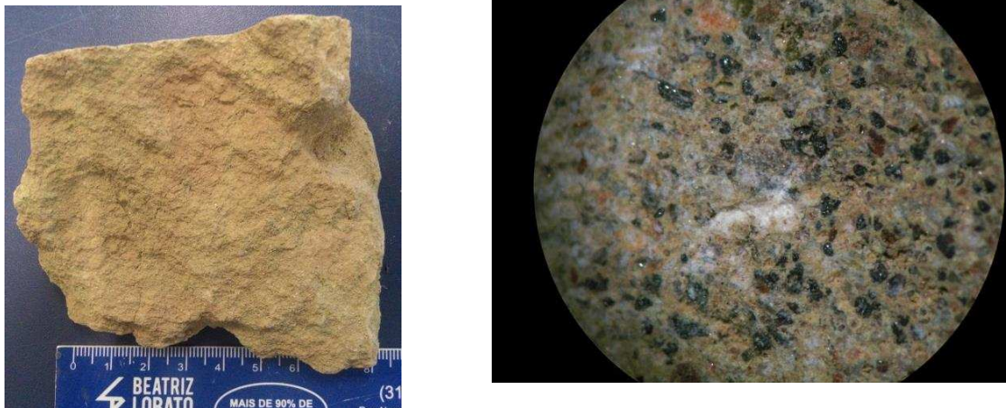
Figura 36- Classe de intemperismo IV (HW). ). À esquerda amostra de mão e à direita imagem tirada em lupa com aumento de 80x.
