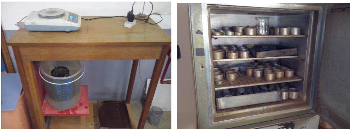
(a) (b) Figura 22 - Amostras em imersão (a) e amostras na estufa (b).
