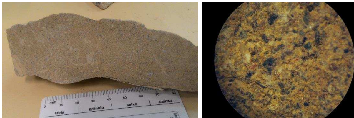
Figura 31- Exemplo de arenito na classe de intemperismo II a (SW), P07. À esquerda amostra de mão e à direita imagem tirada em lupa com aumento de 80x.
