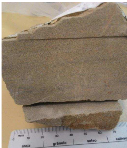
Figura 33 – Exemplo de arenito classe de intemperismo II/III (SW a MW). À esquerda amostra de mão e à direita imagem tirada em lupa com aumento de 80x.
