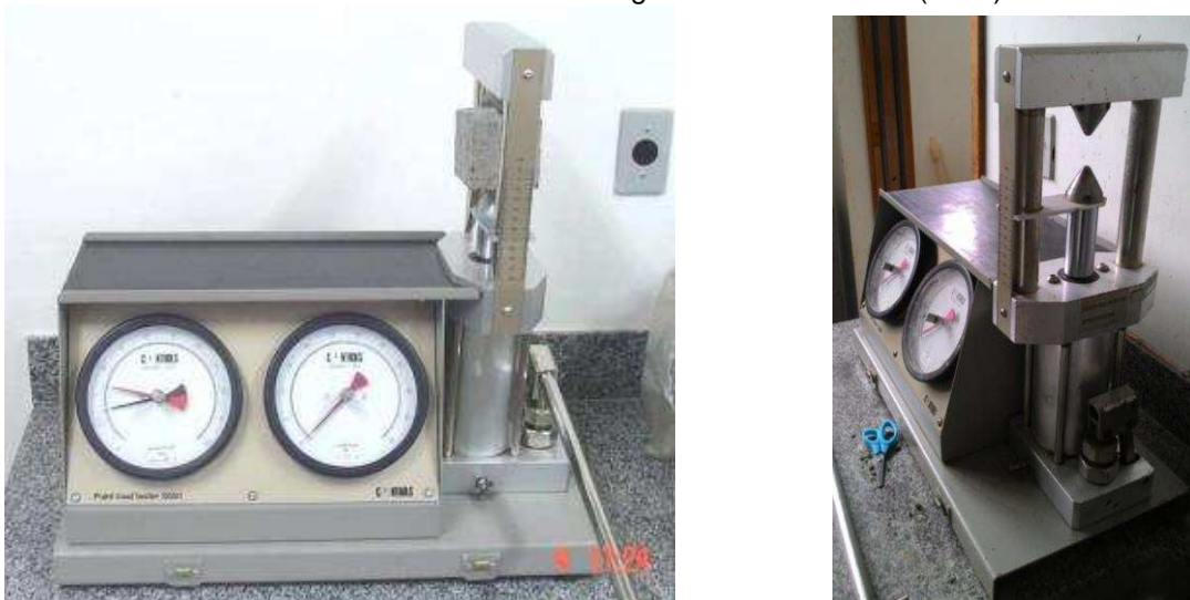
Figura 16- Equipamento utilizado para o ensaio de resistência à compressão puntiforme.
