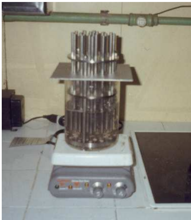
Figura 2 – Cozedor de Mattson sobre placa aquecedora.
