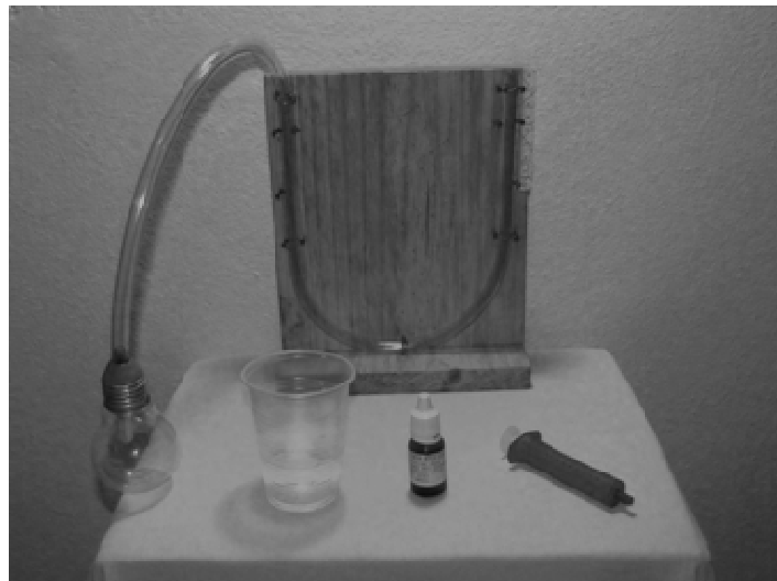
Figura 3: Montagem do termoscópio junto aos outros materiais utilizados.
