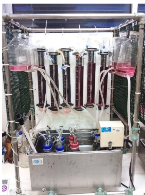
Figura 1 – Montagem experimental dos reatores anaeróbios em co-digestão.
