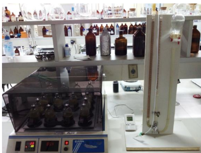
Figura 5 – Incubadora com agitação e sistema de vaso comunicante utilizado para amostragem de biogás.
