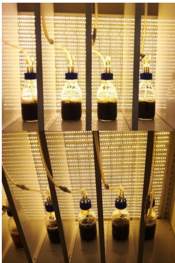
Figura 7 – As culturas de microalgas cultivadas em fotobiorreatores. A iluminação foi fornecida por meio de uma placa de luz composta por faixas de LED brancas.
