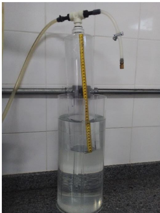
Figura 6 – Gasômetro acoplado ao biodigestor UASB utilizado para o armazenando do biogás.
