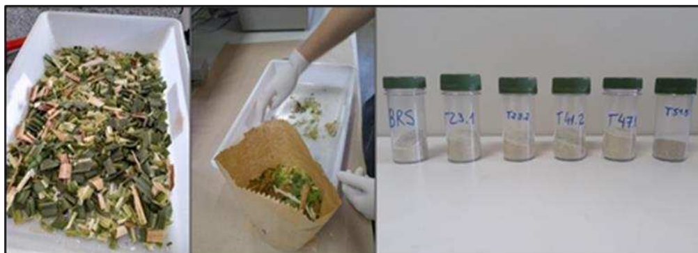
Figura 3 – Método de preparo da amostra de bagaço: (a) amostra triturada; (b) amostra separada para obtenção de matéria seca; e (c) moagem fina de bagaço para análise.
