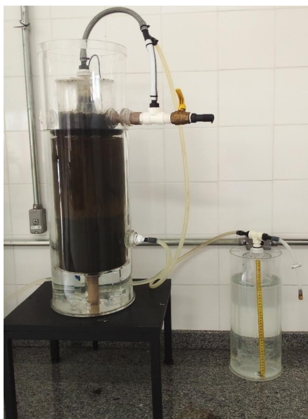
Figura 4 – Biodigestor modelo UASB de acrílico construído para experimento.
