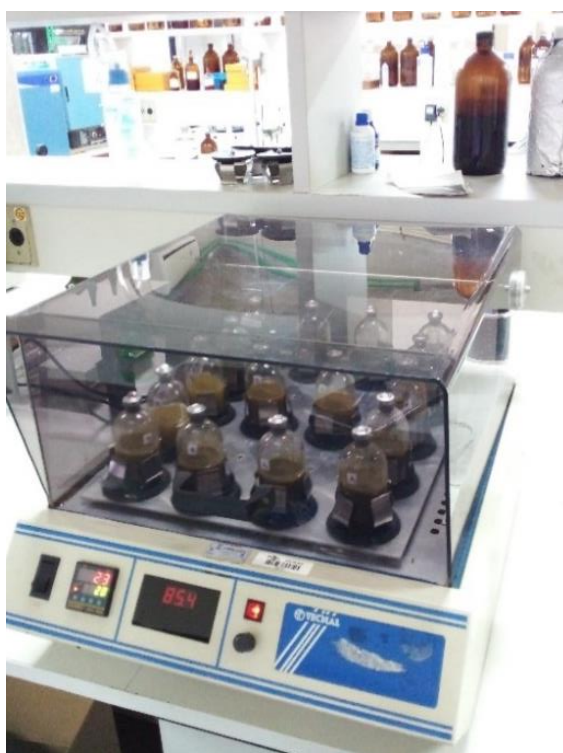
Figura 3 – Montagem dos ensaios em batelada na incubadora shaker.
