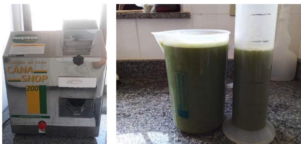
Figura 1 – Moenda semi-industrial para moagem dos colmos do capim-elefante.
