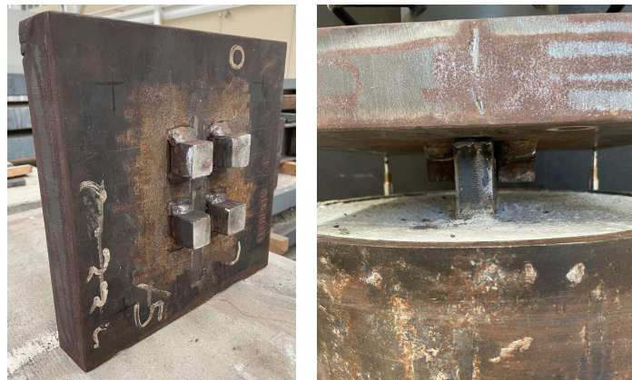
Figura 33 – Chapa de transferência de carga e seu posicionamento na chapa central durante o ensaio.
