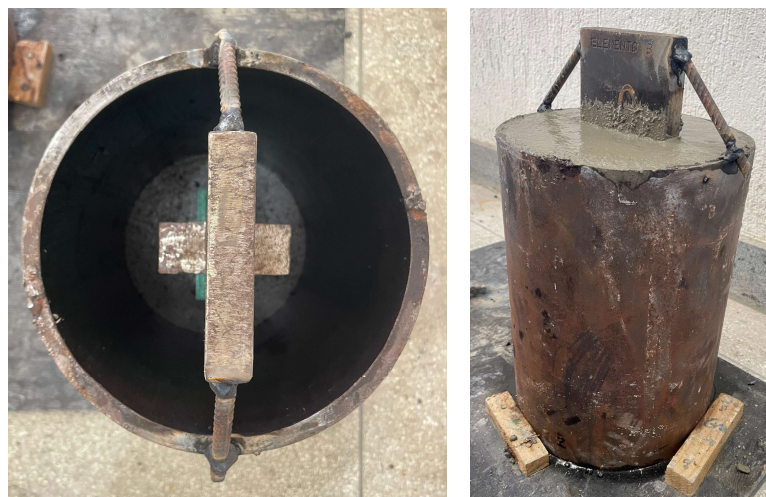
Figura 25 – Soldagem de barras de aço nervuradas para auxiliar na estabilidade da chapa e no transporte do corpo de prova.
