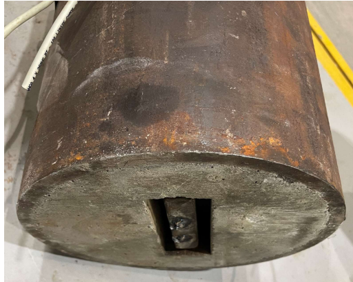
Figura 40 – Região inferior do modelo TB1-219-30-1 após a finalização do ensaio.
