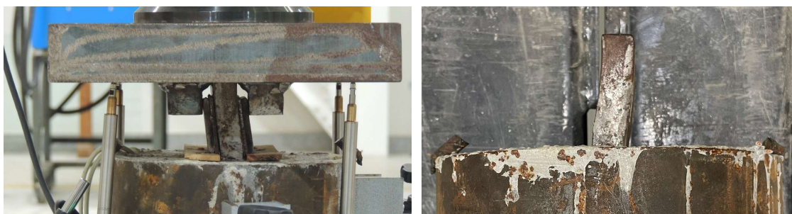
Figura B.8 - Aspecto da deformada da chapa central ao final do ensaio do modelo TB1-219-30-2.
